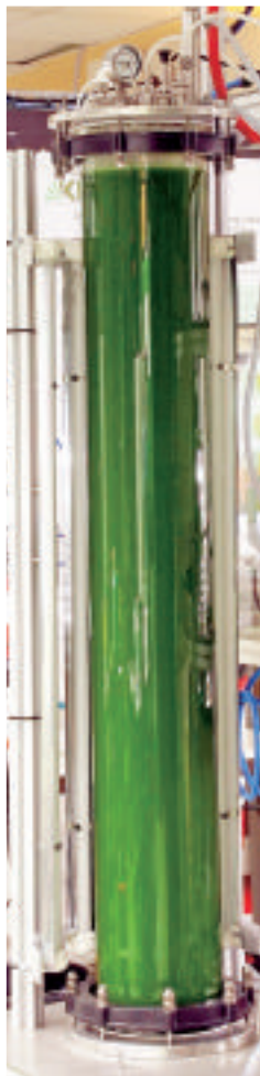
Pokončni fotobioreaktor za gojenje mikroalg je mogoče kluže do ekonomske rabe mikroalgalne biomase za pogonska goriva. © KIT Nemčija
